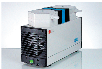
Bomba de membrana para vacío N-820 Especial para disolventes. Volumen de flujo 20 litros/minuto. Límite de vacío 8 mbar. Cabezales en PTFE. Membranas teflonadas, válvulas en FFPM, nivel de protección del motor IP-44 Código 5910009
