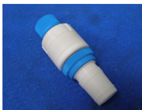
Guia para agitadores PTFE 29/32 Ø 10 MM Alta resistencia química Vacio bajo (5 mmHg) Presión (3-5psi) Sello de rodamiento de precisión de PTFE / PEEK / vidrio de alto rendimiento Manguito anti-batidor interno Código 1001788
