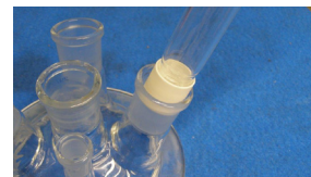
Guia para agitadores PTFE 29/32 Ø 10 MM Alta resistencia química Vacio bajo (5 mmHg) Presión (3-5psi) Sello de rodamiento de precisión de PTFE / PEEK / vidrio de alto rendimiento Manguito anti-batidor interno Código 1001788
